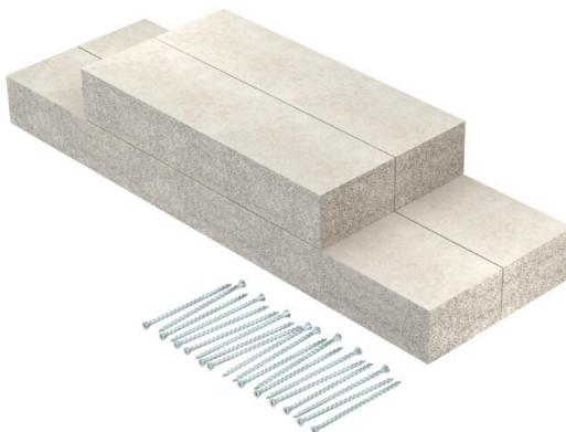
Cuello de corriente para pared para canal de protección contra el fuego PYROLI-NE® Con S EI60, tipo PLCS D061220 compuesto por hormigón ligero con fibra de vidrio, resistente al agua y a las heladas para el montaje en el canal de protección contra el fuego en el área de las conexiones de pared y los tendidos de pared. Compuesto de 4 placas individuales (anchura 50 mm, grosor 30 mm). Incluidos tornillos de cabeza avellanada. Incluidos tornillos de cabeza avellanada.
