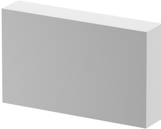
Junta de espuma adaptable de forma flexible para el canal de instalación PYRO-LINE® Rapid PLM para el sellado de haces de cables o cables con un gran diámetro exterior cuando los cables son conducidos fuera del canal de instalación. La superficie debe sellarse adicionalmente con la pintura intumesciente ASX.
