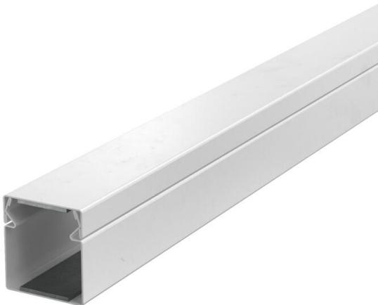
Canal de instalación de metal con tejido ignífugo intumesciente para el tendido de cables a prueba de incendios. Clasificado como canal de instalación EI30, EI60 y EI90 según EN 13501-2, probado según EN 1366-5. El canal impide durante el periodo de tiempo clasificado que el incendio se propague y protege contra los efectos de un incendio de cables.
