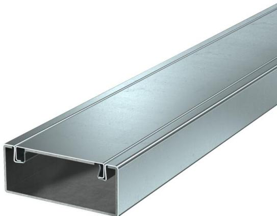
Canal de instalación de metal con tejido ignífugo intumesciente para el tendido de cables a prueba de incendios. Clasificado como canal de instalación EI30, EI60 y EI90 según EN 13501-2, probado según EN 1366-5. El canal impide durante el periodo de tiempo clasificado que el incendio se propague y protege contra los efectos de un incendio de cables.
