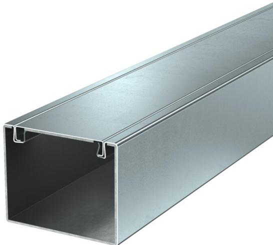
Canal de instalación de metal con tejido ignífugo intumesciente para el tendido de cables a prueba de incendios. Clasificado como canal de instalación EI30, EI60 y EI90 según EN 13501-2, probado según EN 1366-5. El canal impide durante el periodo de tiempo clasificado que el incendio se propague y protege contra los efectos de un incendio de cables.
