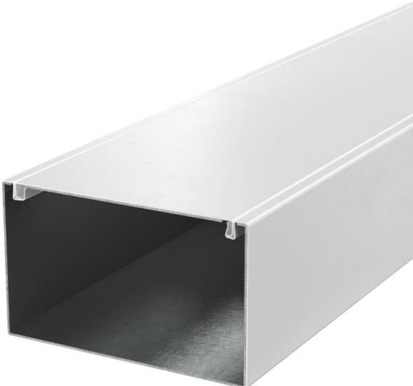
Canal de instalación de metal con tejido ignífugo intumesciente para el tendido de cables a prueba de incendios. Clasificado como canal de instalación EI30, EI60 y EI90 según EN 13501-2, probado según EN 1366-5. El canal impide durante el periodo de tiempo clasificado que el incendio se propague y protege contra los efectos de un incendio de cables.
