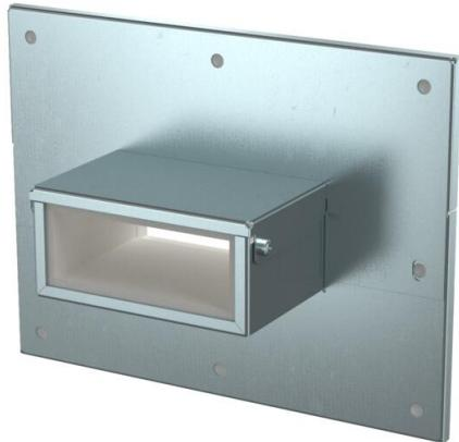
Unión a pared, 4 lados con junta integrada para el canal de instalación PYROLINE® Rapid PLM. Para montaje en la zona de las conexiones de pared y techo, así como conductos de pared. También puede utilizarse como unión a pared de 3 lados para el montaje directo en paredes y techos del canal.
