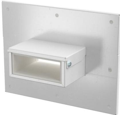
Unión a pared, 4 lados con junta integrada para el canal de instalación PYROLINI® Rapid PLM. Para montaje en la zona de las conexiones de pared y techo, así como conductos de pared. También puede utilizarse como unión a pared de 3 lados para el montaje directo en paredes y techos del canal.
