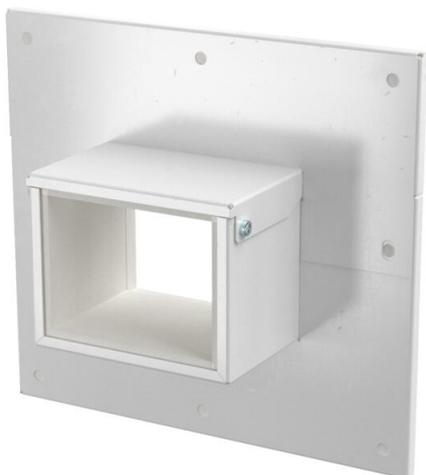
Unión a pared, 4 lados con junta integrada para el canal de instalación PYROLI-NE® Rapid PLM. Para montaje en la zona de las conexiones de pared y techo, así como conductos de pared. También puede utilizarse como unión a pared de 3 lados para el montaje directo en paredes y techos del canal.
