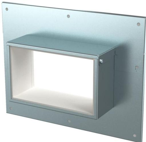
Unión a pared, 4 lados con junta integrada para el canal de instalación PYROLINE® Rapid PLM. Para montaje en la zona de las conexiones de pared y techo, así como conductos de pared. También puede utilizarse como unión a pared de 3 lados para el montaje directo en paredes y techos del canal.
