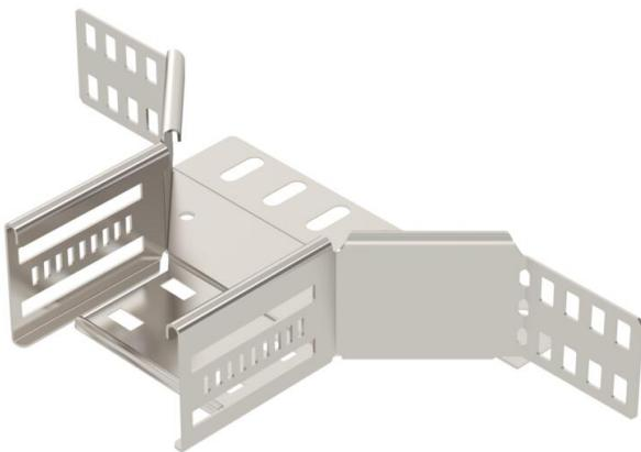
Derivaciones simples para establecer una derivación horizontal o cruce, accesorio para bandejas portacables encajables y atornillables con ala de 60 mm. Montaje sin tornillos con abrazaderas dobles o unión atornillada con tornillos redondos planos FRS y tuercas combinadas M6. De uso en interiores y exteriores. El material de fijación se debe pedir por separado.
