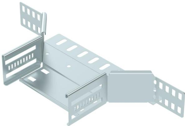
Derivaciones simples para establecer una derivación horizontal o cruce, accesorio para bandejas portacables encajables y atornillables con ala de 60 mm. Montaje sin tornillos con abrazaderas dobles o unión atornillada con tornillos redondos planos FRS y tuercas combinadas M6. De uso en espacio interior. El material de fijación se debe pedir por separado.
