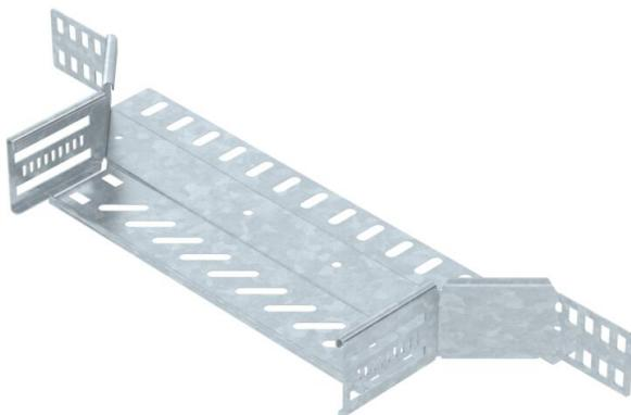
Derivaciones simples para establecer una derivación horizontal o cruce, accesorio para bandejas portacables encajables y atornillables con ala de 60 mm. Montaje sin tornillos con abrazaderas dobles o unión atornillada con tornillos redondos planos FRS y tuercas combinadas M6. De uso en interiores y exteriores. El material de fijación se debe pedir por separado.
