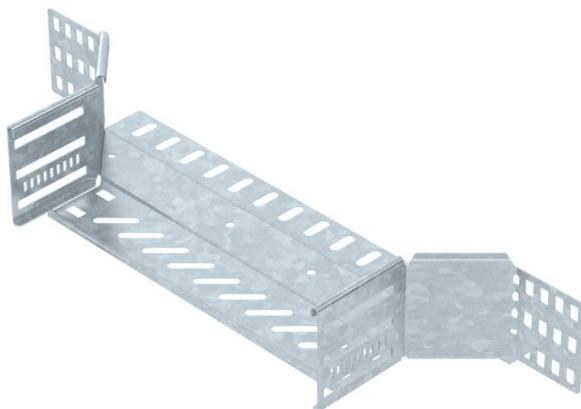
Derivaciones simples para establecer una derivación horizontal o cruce, accesorio para bandejas portacables encajables y atornillables con ala de 85 mm. Montaje sin tornillos con abrazaderas dobles o unión atornillada con tornillos redondos planos FRS y tuercas combinadas M6. De uso en interiores y exteriores. El material de fijación se debe pedir por separado.
