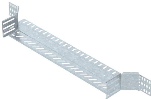
Derivaciones simples para establecer una derivación horizontal o cruce, accesorio para bandejas portacables encajables y atornillables con ala de 85 mm. Montaje sin tornillos con abrazaderas dobles o unión atornillada con tornillos redondos planos FRS y tuercas combinadas M6. De uso en interiores y exteriores. El material de fijación se debe pedir por separado.
