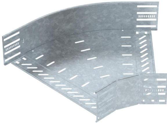
Curva de 45° para establecer una derivación horizontal, accesorio para bandejas portacables encajables y atornillables con ala de 110 mm. Montaje sin tornillos con abrazaderas dobles o unión atornillada con tornillos redondos planos FRS y tuercas combinadas M6. De uso en interiores y exteriores. El material de fijación se debe pedir por separado.
