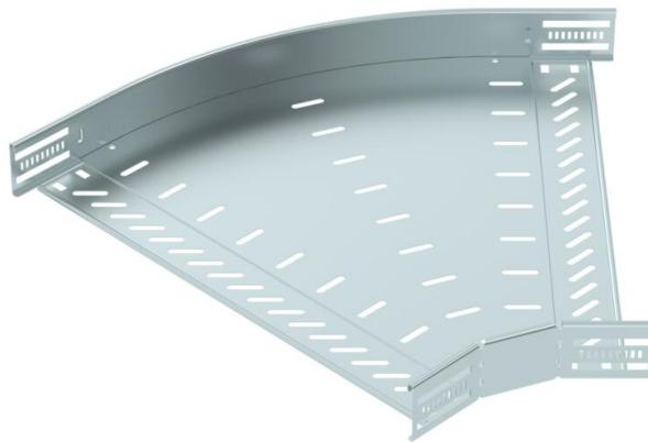
Curva de 45° para establecer una derivación horizontal, accesorio para bandejas portacables encajables y atornillables con ala de 60 mm. Montaje sin tornillos con abrazaderas dobles o unión atornillada con tornillos redondos planos FRS y tuercas combinadas M6. De uso en espacio interior. El material de fijación se debe pedir por separado.
