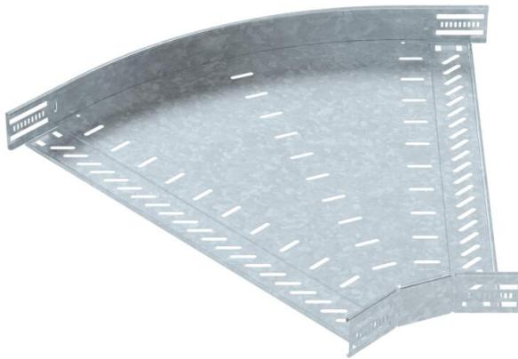
Curva de 45° para establecer una derivación horizontal, accesorio para bandejas portacables encajables y atornillables con ala de 60 mm. Montaje sin tornillos con abrazaderas dobles o unión atornillada con tornillos redondos planos FRS y tuercas combinadas M6. De uso en interiores y exteriores. El material de fijación se debe pedir por separado.
