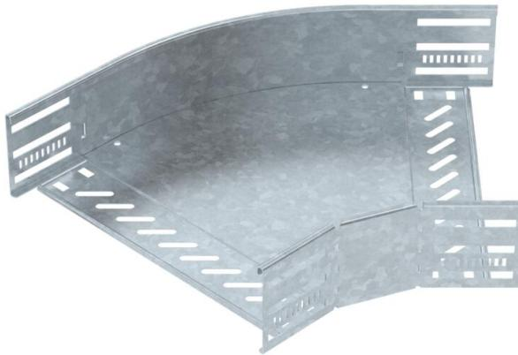
Curva de 45° para establecer una derivación horizontal, accesorio para bandejas portacables encajables y atornillables con ala de 85 mm. Montaje sin tornillos con abrazaderas dobles o unión atornillada con tornillos redondos planos FRS y tuercas combinadas M6. De uso en interiores y exteriores. El material de fijación se debe pedir por separado.
