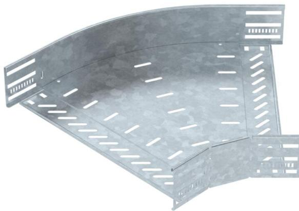
Curva de 45° para establecer una derivación horizontal, accesorio para bandejas portacables encajables y atornillables con ala de 85 mm. Montaje sin tornillos con abrazaderas dobles o unión atornillada con tornillos redondos planos FRS y tuercas combinadas M6. De uso en interiores y exteriores. El material de fijación se debe pedir por separado.
