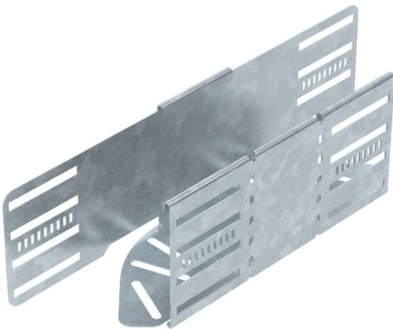
Curva de ángulo regulable para establecer una derivación horizontal, accesorio para bandejas portacables encajables y atornillables con ala de 110 mm. Ángulo regulable de 0-90 °. Montaje sin tornillos con abrazaderas dobles o unión atornillada con tornillos redondos planos FRS y tuercas combinadas M6. De uso en interiores y exteriores. El material de fijación se debe pedir por separado.
