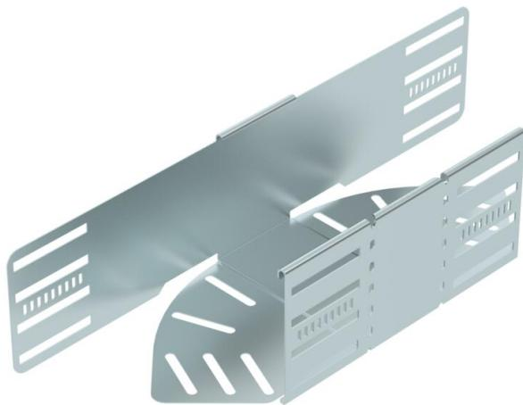
Curva de ángulo regulable para establecer una derivación horizontal, accesorio para bandejas portacables encajables y atornillables con ala de 110 mm. Ángulo regulable de 0-90 °. Montaje sin tornillos con abrazaderas dobles o unión atornillada con tornillos redondos planos FRS y tuercas combinadas M6. De uso en espacio interior. El material de fijación se debe pedir por separado.
