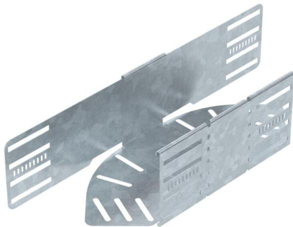
Curva de ángulo regulable para establecer una derivación horizontal, accesorio para bandejas portacables encajables y atornillables con ala de 110 mm. Ángulo regulable de 0-90 °. Montaje sin tornillos con abrazaderas dobles o unión atornillada con tornillos redondos planos FRS y tuercas combinadas M6. De uso en interiores y exteriores. El material de fijación se debe pedir por separado.
