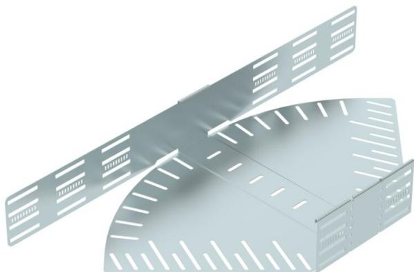
Curva de ángulo regulable para establecer una derivación horizontal, accesorio para bandejas portacables encajables y atornillables con ala de 110 mm. Ángulo regulable de 0-90 °. Montaje sin tornillos con abrazaderas dobles o unión atornillada con tornillos redondos planos FRS y tuercas combinadas M6. De uso en espacio interior. El material de fijación se debe pedir por separado.
