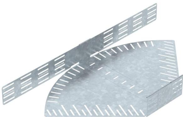
Curva de ángulo regulable para establecer una derivación horizontal, accesorio para bandejas portacables encajables y atornillables con ala de 110 mm. Ángulo regulable de 0-90 °. Montaje sin tornillos con abrazaderas dobles o unión atornillada con tornillos redondos planos FRS y tuercas combinadas M6. De uso en interiores y exteriores. El material de fijación se debe pedir por separado.
