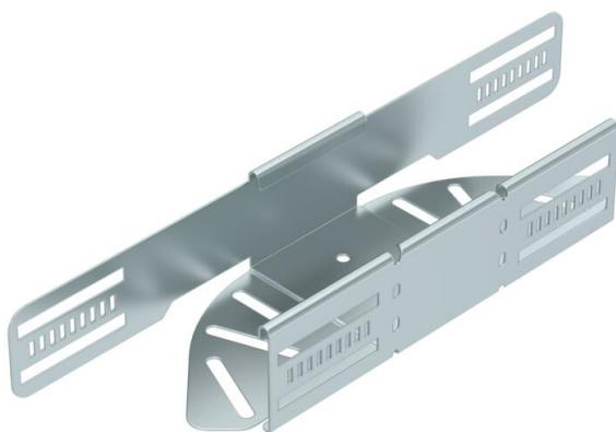
Curva de ángulo regulable para establecer una derivación horizontal, accesorio para bandejas portacables encajables y atornillables con ala de 60 mm. Ángulo regulable de 0-90 °. Montaje sin tornillos con abrazaderas dobles o unión atornillada con tornillos redondos planos FRS y tuercas combinadas M6. De uso en espacio interior. El material de fijación se debe pedir por separado.
