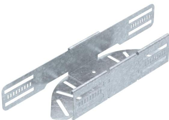
Curva de ángulo regulable para establecer una derivación horizontal, accesorio para bandejas portacables encajables y atornillables con ala de 60 mm. Ángulo regulable de 0-90 °. Montaje sin tornillos con abrazaderas dobles o unión atornillada con tornillos redondos planos FRS y tuercas combinadas M6. De uso en interiores y exteriores. El material de fijación se debe pedir por separado.
