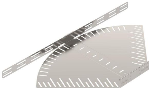
Curva de ángulo regulable para establecer una derivación horizontal, accesorio para bandejas portacables encajables y atornillables con ala de 60 mm. Ángulo regulable de 0-90 °. Montaje sin tornillos con abrazaderas dobles o unión atornillada con tornillos redondos planos FRS y tuercas combinadas M6. De uso en interiores y exteriores. El material de fijación se debe pedir por separado.
