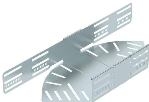
Curva de ángulo regulable para establecer una derivación horizontal, accesorio para bandejas portacables encajables y atornillables con ala de 85 mm. Ángulo regulable de 0-90 °. Montaje sin tornillos con abrazaderas dobles o unión atornillada con tornillos redondos planos FRS y tuercas combinadas M6. De uso en espacio interior. El material de fijación se debe pedir por separado.
