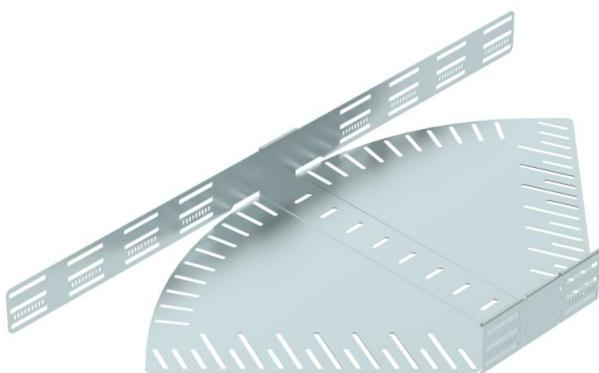
Curva de ángulo regulable para establecer una derivación horizontal, accesorio para bandejas portacables encajables y atornillables con ala de 85 mm. Ángulo regulable de 0-90 °. Montaje sin tornillos con abrazaderas dobles o unión atornillada con tornillos redondos planos FRS y tuercas combinadas M6. De uso en espacio interior. El material de fijación se debe pedir por separado.
