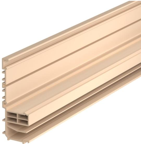
Parte inferior del sistema de canalización Rauduo con 2 cámaras individuales separadas térmicamente para el tendido conjunto de cables eléctricos y de calefacción. Con función de retención para el alojamiento de las tapas del canal. El color de las bases de canal puede variar condicionado por la fabricación. Cámara inferior para el montaje de cables eléctrico con tabique de separación extrusionado para el tendido por separado de alta y baja tensión. Orificio de la base de serie.
