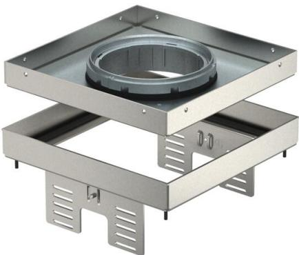
Caja nivelable y desacoplada del suelo del tamaño nominal 4, para tubo, para el montaje de sistemas de instalación en suelos que requieren limpieza en seco o con agua en zonas interiores, para el montaje en cajas bajo suelo UZD250 o UZD350, cada una en combinación con una tapa de montaje DUG./4 o en UGD250-3/4 o UGD350-3/4. El montaje se efectúa mediante ángulos de nivelación (pedir por separado) en el perfil del marco de aluminio de las cajas bajo suelo.
