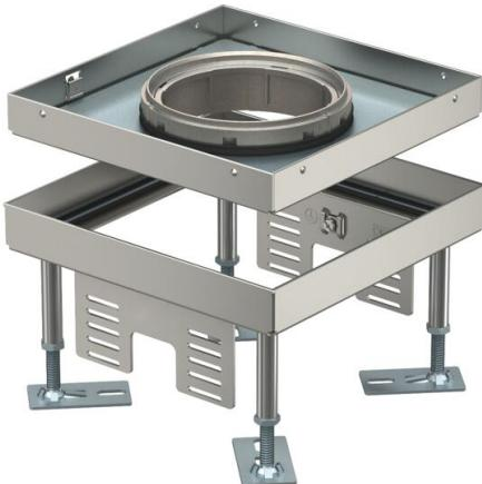
Conjunto de tapa y marco cuadrado de altura regulable para tubos de tamaño nominal 4 para montar dispositivos de instalación en sistemas de canalización, suelos dobles y huecos en suelos limpiados en seco o en húmedo en interiores. Clase de protección: IP X5.
