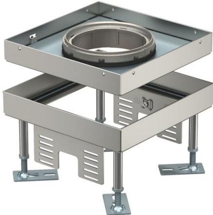
Conjunto de tapa y marco cuadrado de altura regulable y alta resistencia para tubos de tamaño nominal 4 para montar dispositivos de instalación en sistemas de canalización, suelos dobles y huecos en suelos limpiados en seco o en húmedo en interiores. Clase de carga 1 a 10 kN.
