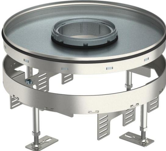
Tapa y marco redondos para cargas pesadas, con orificio para tubo, de tamaño R9, para el montaje de mecanismos en sistemas de canalización y en suelos técnicos y huecos, para pavimentos que precisan una limpieza en seco o con agua. Clase de carga 2 hasta 20 kN.
