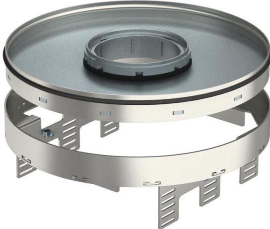
Conjunto de tapa y marco de altura regulable y desacoplada del suelo de tamaño nominal R9, para tubo, para el montaje de mecanismos en pavimentos que precisan limpieza en seco o con agua, para montar en cajas bajo suelo UZD350-3, en combinación con una tapa de montaje DUG350-3R9 o en UGD350-3R9. El montaje se efectúa mediante ángulos de nivelación (pedir por separado) en el perfil del marco de aluminio de las cajas bajo suelo.
