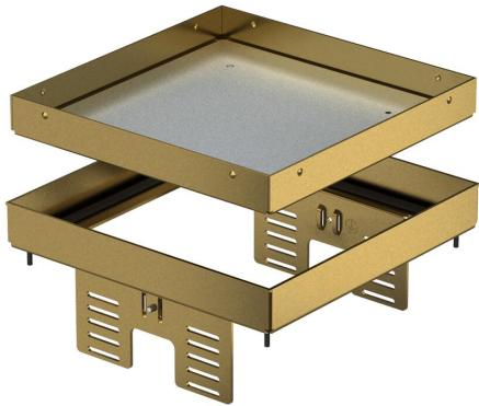
Caja "ciega" nivelable y desacoplada del suelo para crear una abertura para revisiones del tamaño nominal 4 en suelos que requieren limpieza en seco o con agua en zonas interiores, para el montaje en cajas bajo suelo UZD250 o UZD350, cada una en combinación con una tapa de montaje DUG..4 o en UGD250-3/4 o UGD350-3/4. El montaje se efectúa mediante un ángulo de nivelación (pedir por separado) en el perfil del marco de aluminio de las cajas bajo suelo. Sólo son apropiados para pavimentos pulidos.
