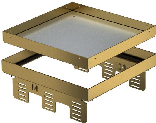
Caja de nivelación "ciega", desacoplada del suelo, para crear una abertura de inspección de tamaño nominal 9 en suelos secos o húmedos en interiores, para instalación en cajas bajo suelo UZD250 o UZD350, en cada caso en combinación con una tapa de montaje DUG./9 o en UGD250-3/9 o UGD350-3/9. El montaje se efectúa mediante un ángulo de nivelación (pedir por separado) en el perfil del marco de aluminio de las cajas bajo suelo. Sólo son apropiados para pavimentos pulidos.
