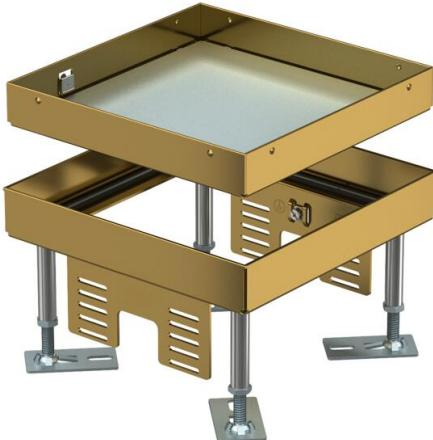
Conjunto de tapa y marco cuadrado "ciego" de altura regulable para crear una abertura de inspección de tamaño nominal 4. Montaje en sistemas de canalización, suelos dobles y huecos en suelos limpiados en seco o en húmedo en interiores. Sólo son apropiados para pavimentos pulidos.
