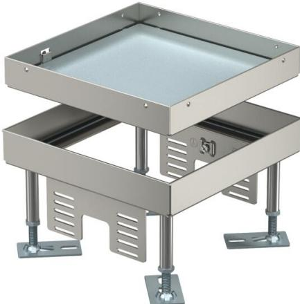
Conjunto de tapa y marco cuadrado de altura regulable y alta resistencia "ciego" de tamaño nominal 4 para crear una abertura de inspección. Montaje en sistemas de canalización, suelos dobles y huecos en suelos limpiados en seco o en húmedo en interiores. Clase de carga 1 a 10 kN. Sólo son apropiados para pavimentos pulidos.
