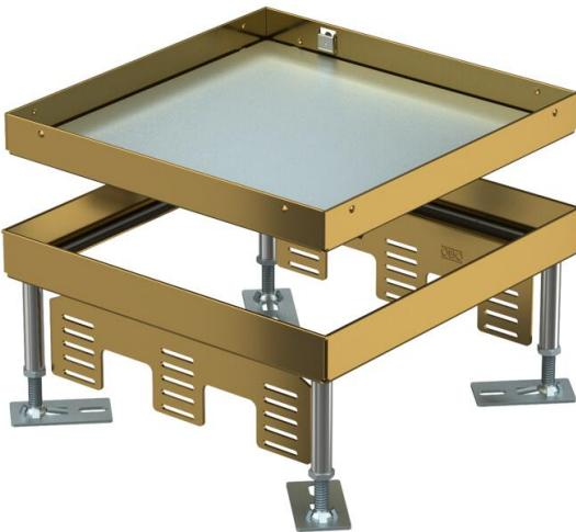
Conjunto de tapa y marco cuadrado "ciego" de altura regulable para crear una abertura de inspección de tamaño nominal 9. Montaje en sistemas de canalización, suelos dobles y huecos en suelos limpiados en seco o en húmedo en interiores. Sólo son apropiados para pavimentos pulidos.
