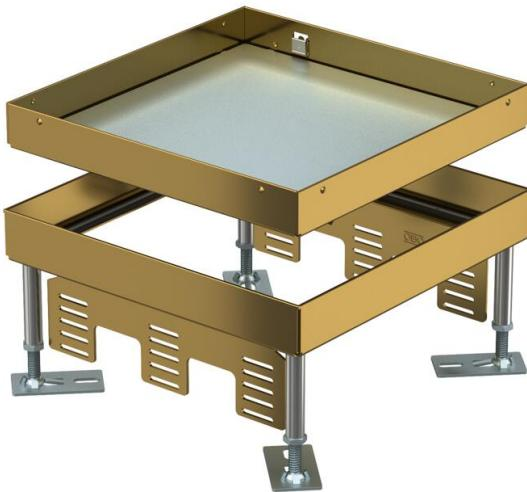
Conjunto de tapa y marco cuadrado "ciego" de altura regulable para crear una abertura de inspección de tamaño nominal 9. Montaje en sistemas de canalización, suelos dobles y huecos en suelos limpiados en seco o en húmedo en interiores. Sólo son apropiados para pavimentos pulidos. Para la instalación de 3 soportes universales UT4 para 9 mecanismos individuales con anillo/estribo de soporte o 12 dispositivos Modul 45®. Pueden instalarse 3 tapas ciegas APMT5.
