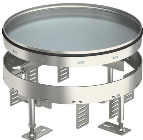
Tapa y marco redondos para cargas pesadas, versión ciega, de tamaño R7, para practicar una abertura de revisión en sistemas de canalización y en suelos técnicos y huecos, para pavimentos que precisan una limpieza en seco o con agua. Clase de carga 2 hasta 20 kN. Sólo son apropiados para pavimentos pulidos.
