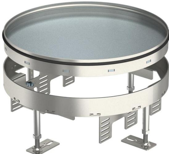
Tapa y marco redondos para cargas pesadas, versión ciega, de tamaño R9, para practicar una abertura de revisión en sistemas de canalización y en suelos técnicos y huecos, para pavimentos que precisan una limpieza en seco o con agua. Clase de carga 2 hasta 20 kN. Sólo son apropiados para pavimentos pulidos.
