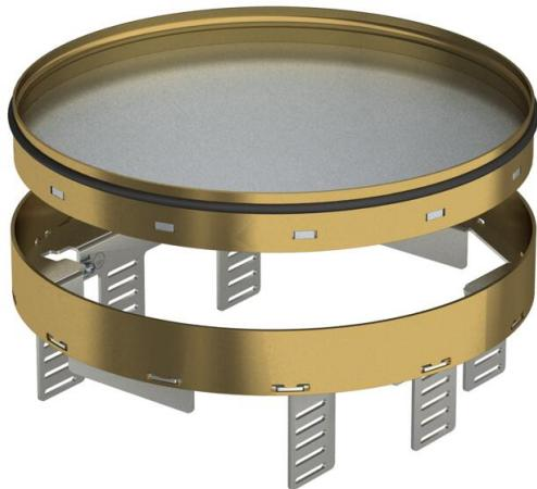
Conjunto ciego de tapa y marco de altura regulable y desacoplada del suelo para crear una abertura de inspección de tamaño nominal R7 en pavimentos que precisan limpieza en seco o con agua, para montar en cajas bajo suelo UZD350-3 en combinación con una tapa de montaje DUG350-3R7 o UGD350-3R7. El montaje se efectúa mediante un ángulo de nivelación (pedir por separado) en el perfil del marco de aluminio de las cajas bajo suelo. Sólo son apropiados para pavimentos pulidos.
