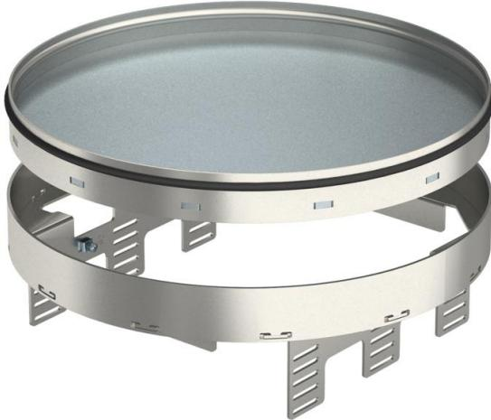
Conjunto ciego de tapa y marco de altura regulable y desacoplada del suelo para crear una abertura de inspección de tamaño nominal R9 en pavimentos que precisan limpieza en seco o con agua, para montar en cajas bajo suelo UZD350-3 en combinación con una tapa de montaje DUG350-3R9 o UGD350-3R9. El montaje se efectúa mediante un ángulo de nivelación (pedir por separado) en el perfil del marco de aluminio de las cajas bajo suelo. Sólo son apropiados para pavimentos pulidos.
