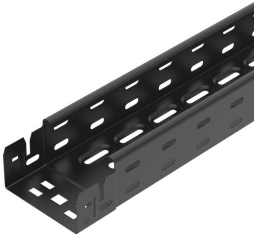
Bandeja portacables con sistema de fijación rápida integrado. Superficie galvanizada en banda, con recubrimiento en polvo de color negro intenso (RAL 9005). Perforación lateral continua de 7 x 20 mm para la instalación de componentes de unión y de montaje adicionales. Con perforación de 11 mm en el suelo para la suspensión directa de la varilla roscada. Longitud útil 3.000 mm. Amortiguación magnética sin tapa 20 dB, con tapa 50 dB.
