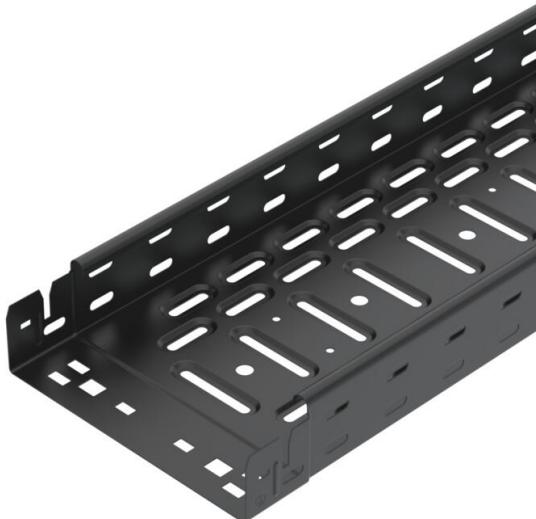
Bandeja portacables con sistema de fijación rápida integrado. Superficie galvanizada en banda, con recubrimiento en polvo de color negro intenso (RAL 9005). Perforación lateral continua de 7 x 20 mm para la instalación de componentes de unión y de montaje adicionales. Con perforación de 11 mm en el suelo para la suspensión directa de la varilla roscada. Longitud útil 3.000 mm. Amortiguación magnética sin tapa 20 dB, con tapa 50 dB.
