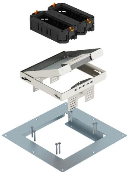
Conjunto de tapa y marco con altura regulable con todos los accesorios de sistema necesarios para el montaje directo en techos huecos en interiores. El volumen de suministro incluye una tapa de montaje y dos soportes universales UT3/45 para tres mecanismos Modul 45® cada uno.
