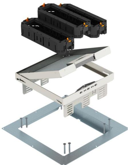
Conjunto de tapa y marco con altura regulable con todos los accesorios de sistema necesarios para el montaje directo en techos huecos en interiores. El volumen de suministro incluye una tapa de montaje y tres soportes universales UT4/45 para cuatro mecanismos Modul 45® cada uno.
